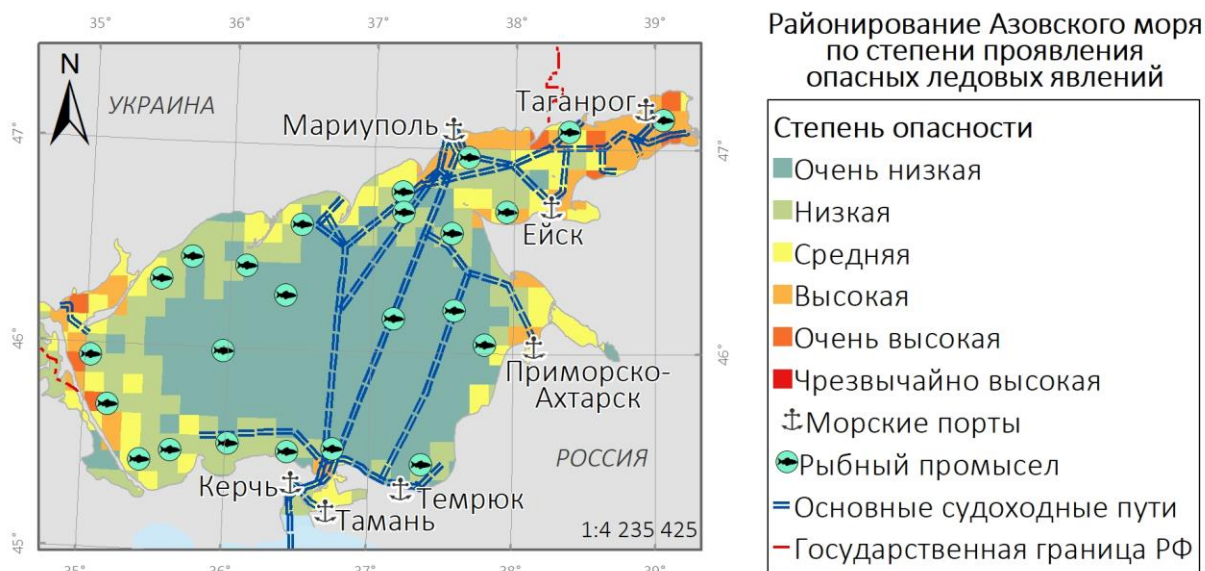
Рисунок 5 – Районирование Азовского моря по степени проявления опасных ледовых явлений
