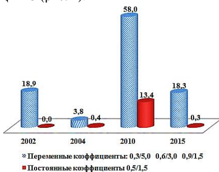
Рис. 2. Относительная погрешность моделирования (%) слоя стаявшего снега при использовании постоянных и переменных коэффициентов экспозиции склонов для водосбора г/п Коса-Коса
