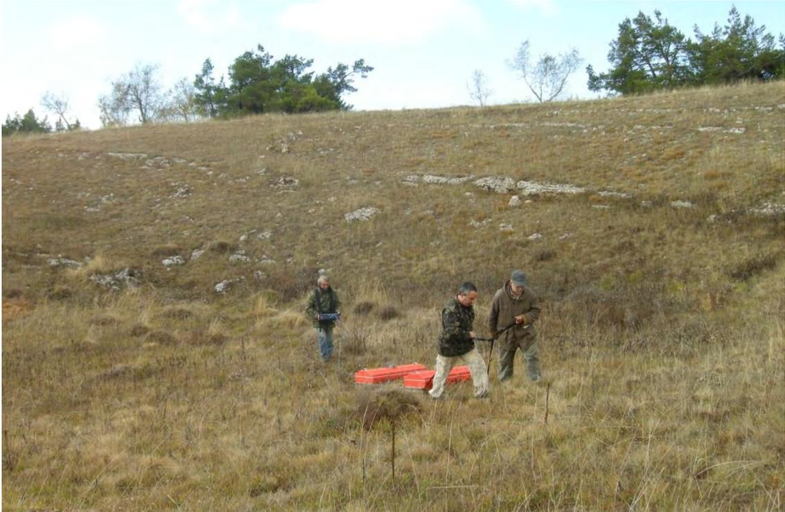
Рис. 2.20. Георадарное профилирование через карстовую воронку на плато массива Ай-Петри.
