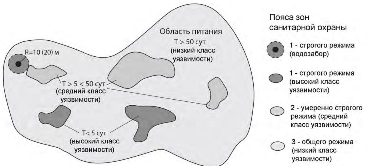
Рис. 5.2. Предлагаемая концептуальная схема установления границ зон санитарной охраны для водозаборов карстовых вод в Горном Крыму на основе карты полной уязвимости подземных вод
