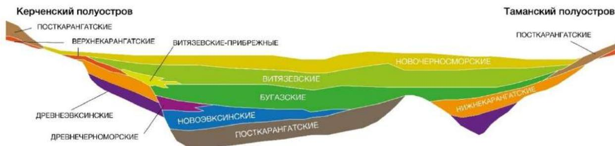
**Рис. 8.** Схематический геологический разрез через Керченский пролив (по материалам бурения Гидропроекта в 1971–1976 гг.). Составлено автором на основе [Федоров, 1978]
