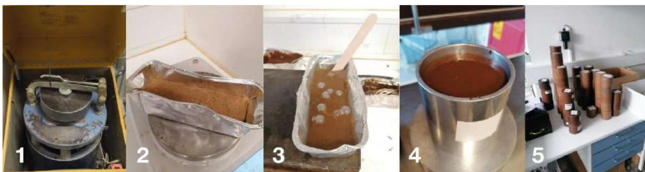
**Рис. 26.** Этапы подготовки образца для гамма-спектрометрии: 1, 2 — измельчение, 3 — смешивание с воском, 4 — заливка в форму, 5 — хранение в течение трех недель для восстановления баланса  $^{220}\text{Rn}$
