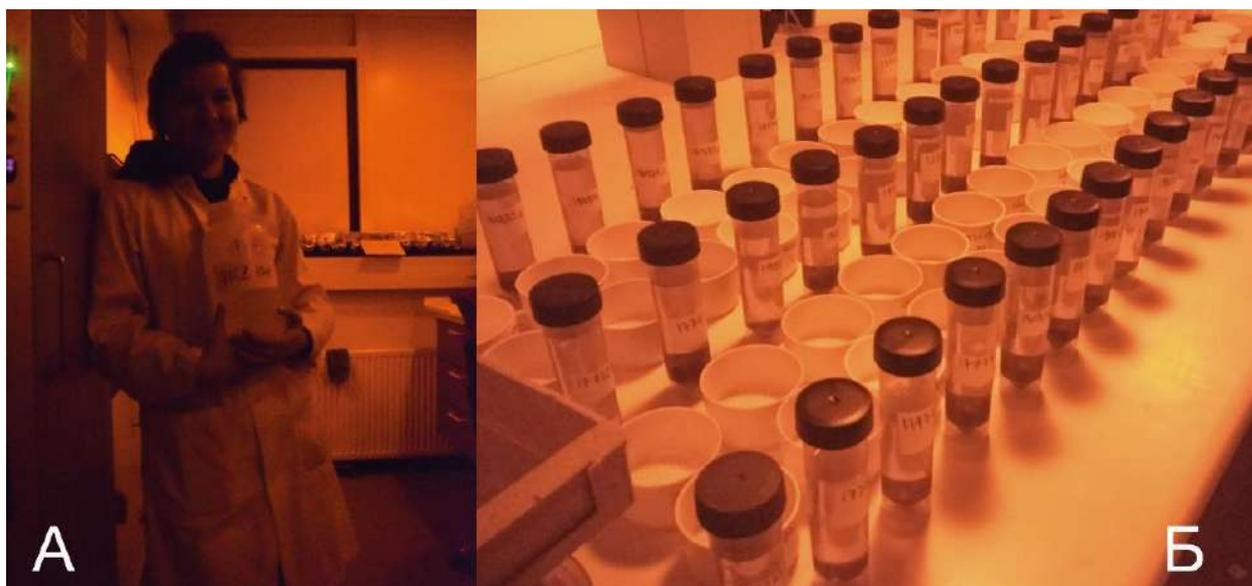
**Рис. 23.** Химическая обработка образцов: А — 10% раствор HCl; Б — сепарация образцов в тяжелой жидкости
