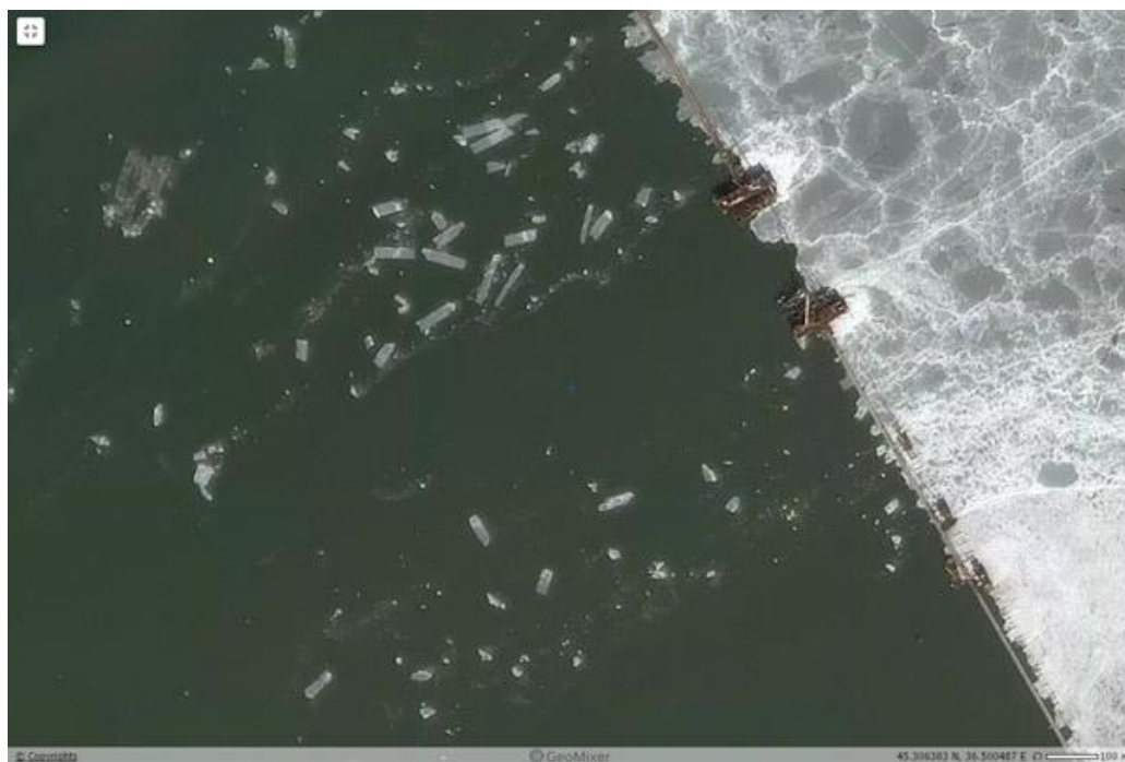
Рисунок 5.11 – Суда, пересекающие крупное ледяное поле, на выходе из Керченского пролива (вверху) и «нарезка» ледяного покрова опорами моста на отдельные льдины-блоки шириной ~20 м (внизу) на фрагментах снимка спутника SPOT-6 от 11.02.2017 (07:54 UTC). © Airbus Defence and Space, СКАНЭКС (Официальный..., 2017)
