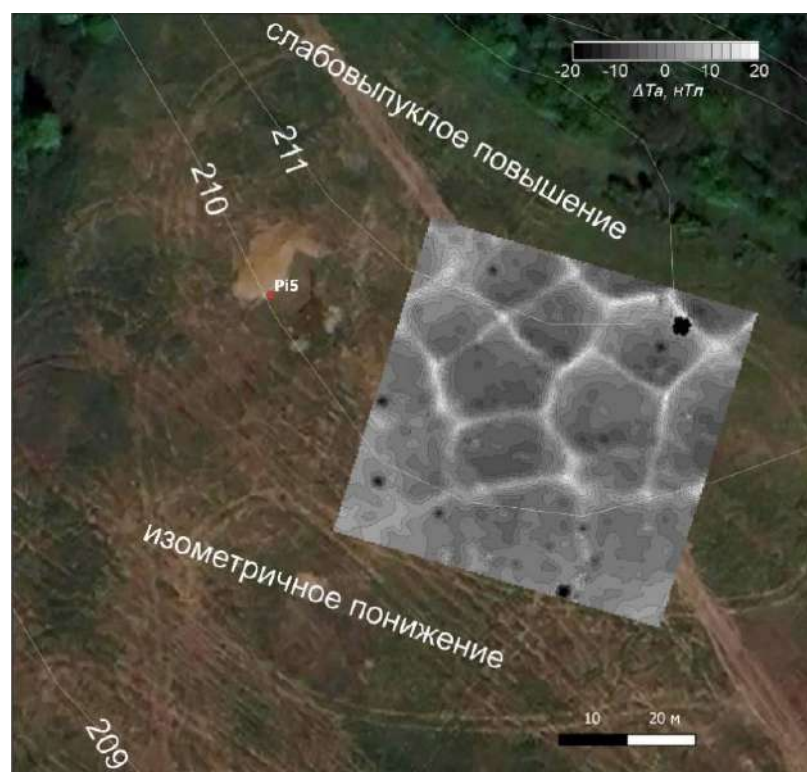
Рис. В4. Аномальное магнитное поле на контакте повышения и понижения микрорельефа вершинной поверхности.
