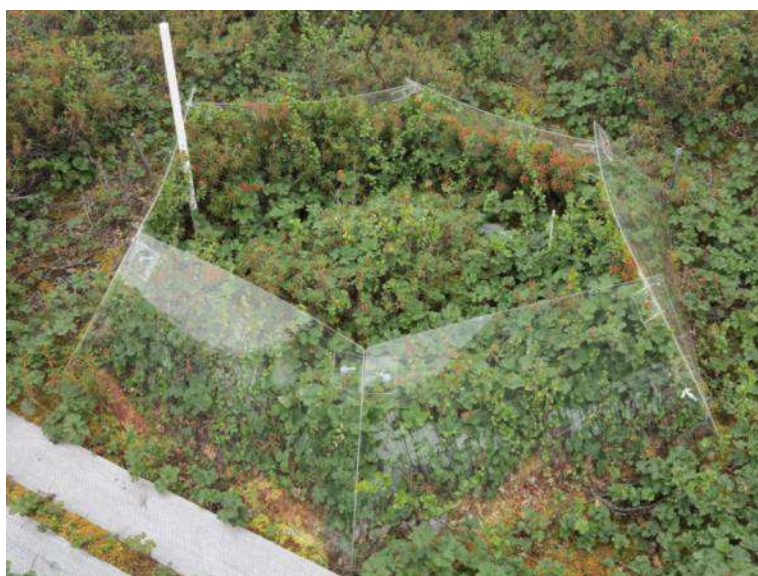
Рисунок 16 – Фото камеры (теплицы), установленной на закусаренной поверхности торфяного бугра.
