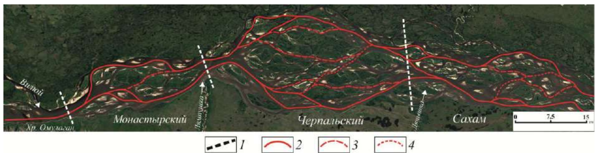
Рисунок 3.23 — Общая схема (космоснимок) разветвленного русла нижней Лены ниже устья Виллой. 1 — границы звеньев разветвлений; 2 — положение стрежневой зоны потока в левом и правом основных рукавах и во вторичных разветвлениях основных рукавов; 3 — то же в субпараллельных рукавах; 4 — то же в диагональных рукавах.
