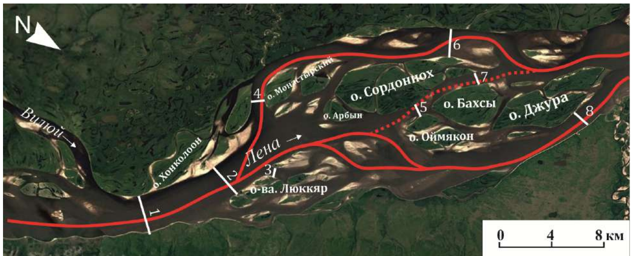
Рисунок 3.24 — Монастырское разветвление (1240–1195 км по судовому ходу). Сплошными линиями показано положение стрежня потока в основных по водности рукавах, пунктирными — квазипоперечные и субпараллельные рукава.
