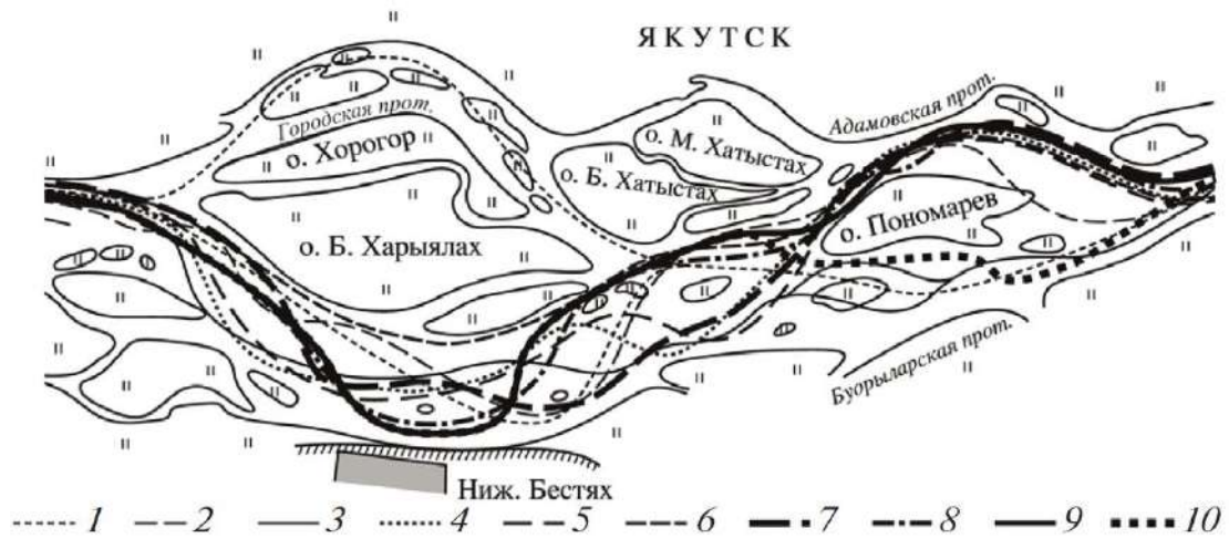
Рисунок 3.15 — Изменения положения судового хода в Бестяхско-Якутском разветвлении (а: 1 — 1929 г.; 2 — 1947 г.; 3 — 1958 г.; 4 — 1963 г.; 5 — 1972 г.; 6 — 1982 г.; 7 — 1989 г.; 8 — 1999 г.; 9 — 2010 г.; 10 — 2015 г.) [Чалов, Завадский и др., 2019].
