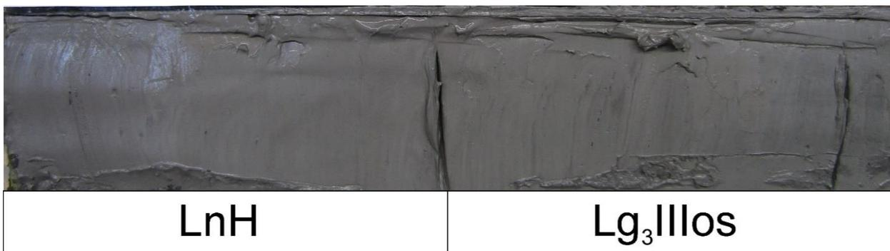
Рис. 35. Контакт между LnH и lg3IIos. Колонка SP-002.
