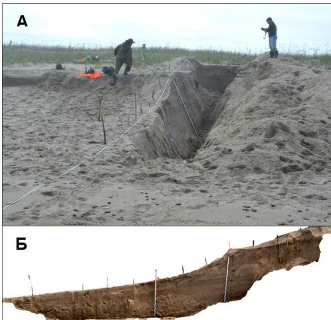
Рисунок 5.8 – Изучение пляжа методом пляжевых разрезов МДС-1 (пересыть лагуны Пильтун): А – подготовка разреза к описанию и отбору проб; Б – ортофотоплан разреза.
