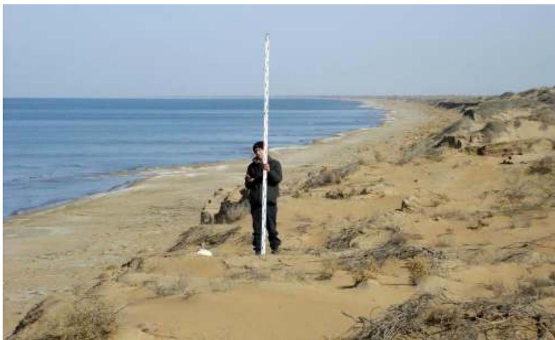
*Рисунок 13. Геодезическая привязка бровки клифа, «Западный Челекен».*
