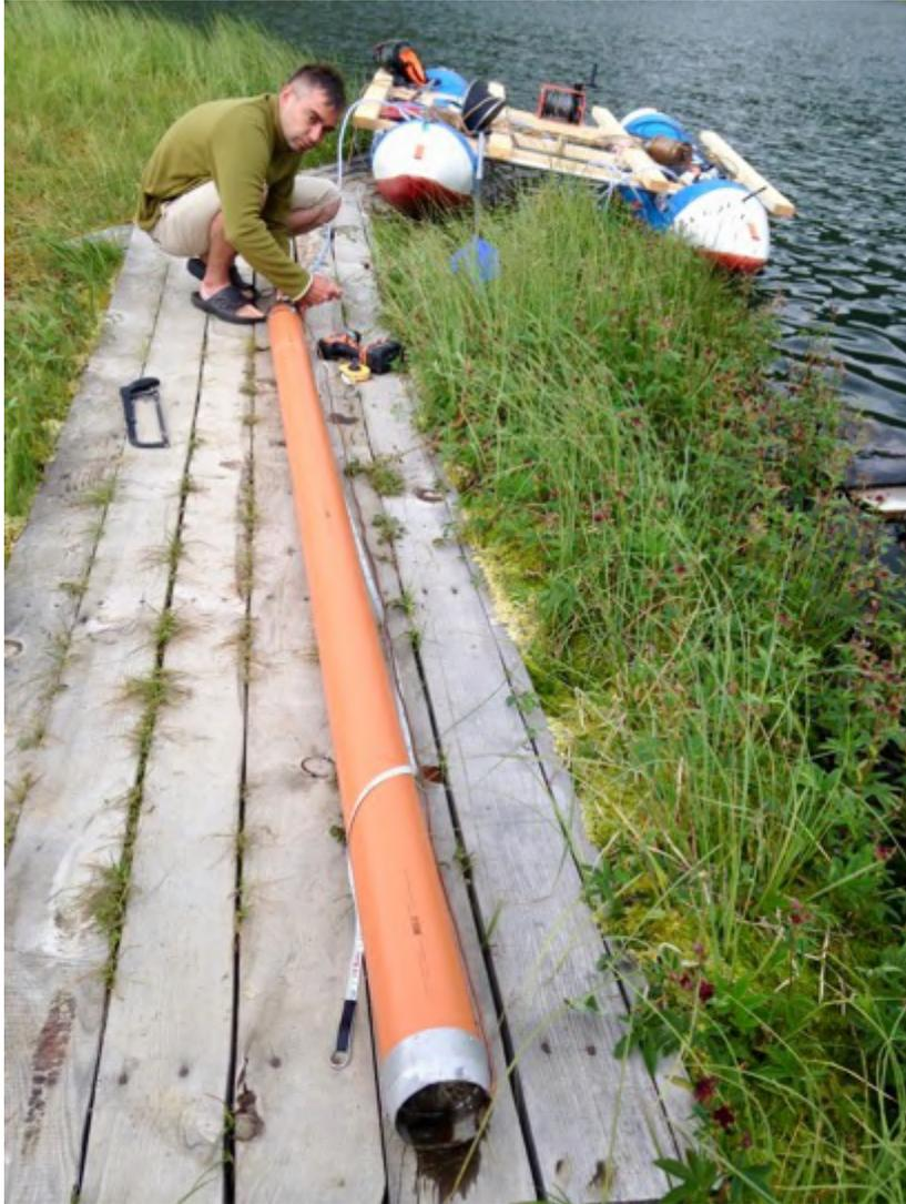
*Рис. 4. Керн, полученный на одном из озер Кавказа с помощью озерного бура конструкции Несье. Фото автора.*
