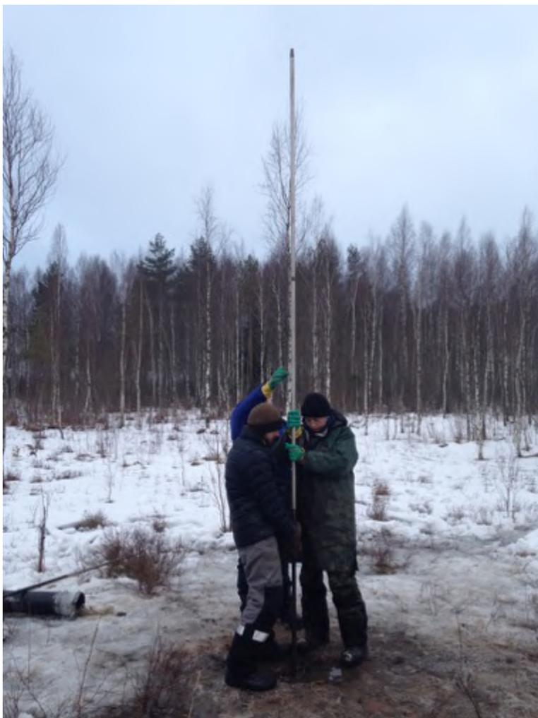
*Рис. 3. Бурение со льда с помощью озерного бура конструкции Ливингстона. Фото автора.*
