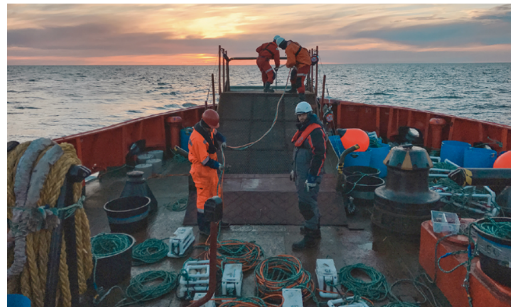
Вахта длится 12 часов. Отрезки интенсивной работы сменяются длительными паузами, когда все имеющееся оборудование уже погружено на дно, и происходит запись электро-магнитного поля.
