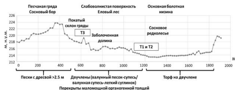
Рис. 2. Относительное положение ключевых траншей и разрезов на геоморфологическом профиле
