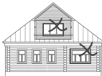
- горизонтальная форма окон, нарушение пропорций соотношения высоты и ширины; расстеловка окон не соответствует исторической, нарушены пропорции
