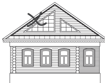
- нетрадиционные формы и пропорции чердачных окон в тимпане фронтона
